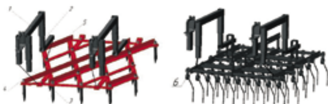
1 – поводок; 2 – стойка съемная задняя; 3 – стойка съемная передняя; 4 – поводок передней зубовой борны (цель 9х27, 7 звеньев); 5 – поводок задней зубовой борны (цель 6х19, 21 звено); 6 – поводок борны пружинной (цель 6х19, 10 звеньев).
