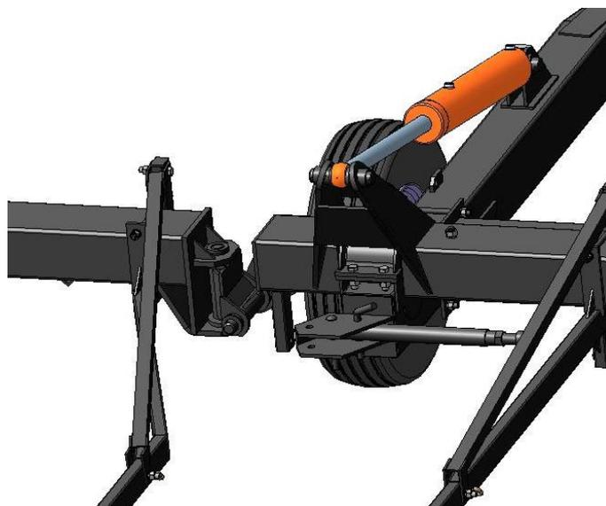
Рисунок 4.14. Правильное положение шарнира при сборке. Сцепка в рабочем положении. (Задняя проушина центрального бруса не показана)
