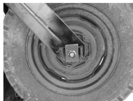
Рисунок 4.4 Крепление переднего колеса на каретке.
