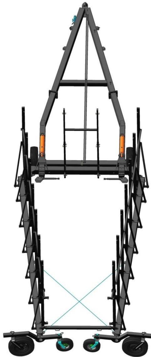
Рисунок 4.11 Вид сцепки в положении «дальний транспорт».
